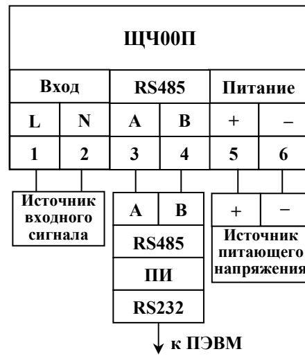
Рисунок Б.1 – Схема подключения приборов ЩЧ00П
